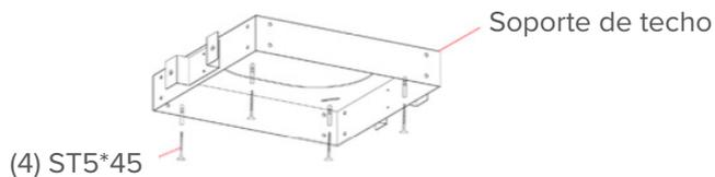
2. Instale el ajuste de soporte y fijación de titular por 16pcs tornillos M4\*10, puede ajustar la longitud de es te paso, a continuación, fijar en cuatro esquinas del cuerpo de la campana por medio de tornillos 16pcs M4\*10, como a continuación:
