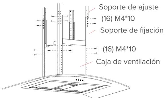
3. Instale la tubería de aire por 2pcs tornillos ST3.2 \* 8.
