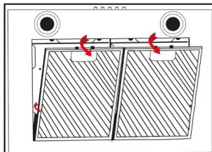
2. Para instalar el filtro de grasa, alinee las pestañas del filtro trasero con las ranuras de la campana. Empuje la lengüeta de cierre de metal, empuje el filtro en su posición y suéltelo.
