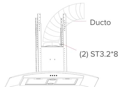
4. Retire la película en la cubierta de la chimenea, ponga la segunda chimenea en la primera chimenea e instalarlos en cuerpo de la campana. A continuación, fije el ajuste de soporte a la unidad de suspensión por 16pcs M4 \* 10, la conexión de enchufe y que se extienden tubo de aire.
