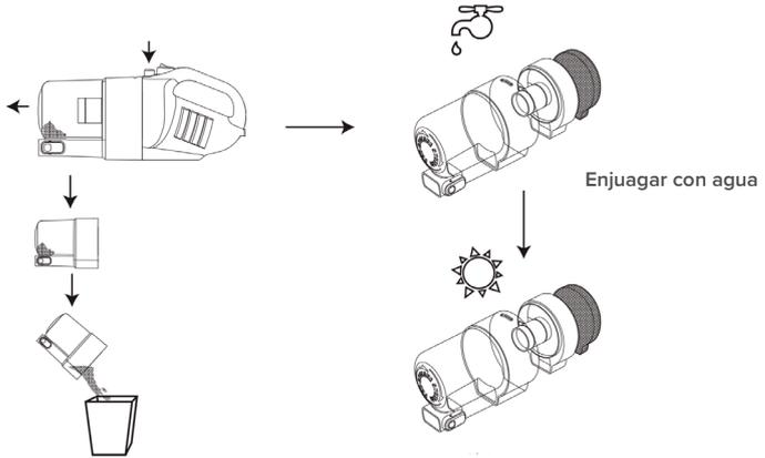
Todos los componentes de la aspiradora deben estar completamente secos antes de que vuelvas a encenderla.
